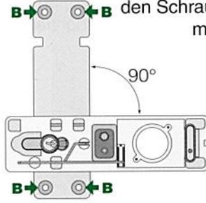
An der gewünschten Position mit Hilfe der Bohrschablone die Löcher für die Schrauben **(B)** bohren.
