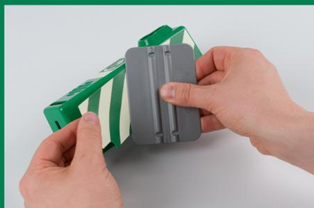
Richten Sie den Aufkleber parallel zur Längsseite aus und orientieren sich dabei an den Schraubenlöchern. Kleben Sie zunächst nur ein schmales Stück auf und streichen dann mit dem Rakel den Rest mit sanftem, gleichmäßigem Druck fest. Wiederholen Sie dies anschließend auf der anderen Seite.
