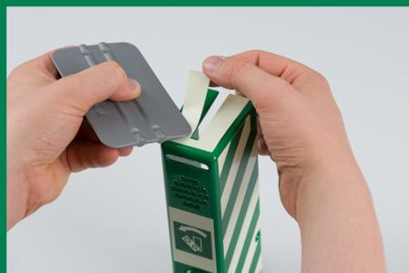
Platzieren Sie die letzte Folie mittig ausgerichtet zur kurzen Kante und verstreichen Sie die beiden Längs-Elemente vorsichtig an der Aussparung entlang.
