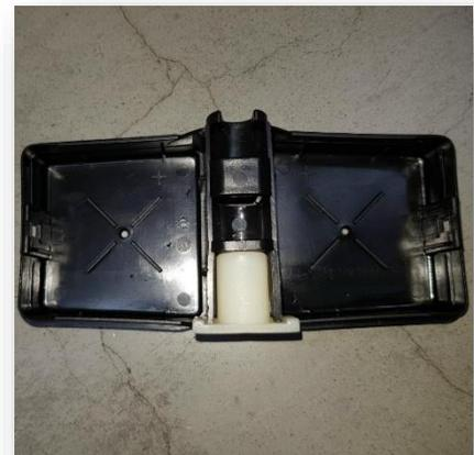
Abschließend müssen Sie nur noch den oberen Teil der Blitzleuchte wieder auf den schwarzen Boden aufstecken und die frontale Schraube wieder eindrehen.
