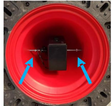
Die Muttern innen an der Außenwand 3 cm Richtung Batteriefach drehen.
