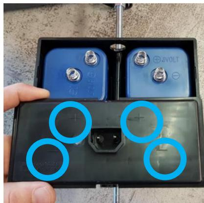
Batterien entnehmen. Neue Batterien vom Typ 4R25 einsetzen, im Absperrshop.de erhältlich. Achten Sie auf die korrekte Position der + und – Pole der Batterien. Diese erkennen Sie auf dem Deckel des Batteriegehäuses. In umgekehrter Reihenfolge wieder zusammensetzen.
