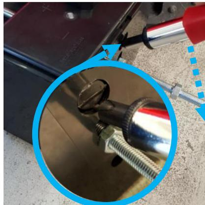
Einen Schlitz-Schraubendreher an der Lasche ansetzen und das Innenteil vom Batteriegehäuse nach oben hebeln. Auf der anderen Seite wiederholen.
