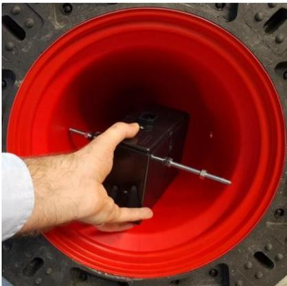
Jetzt das Batteriegehäuse aus dem Leitkegel nehmen.
