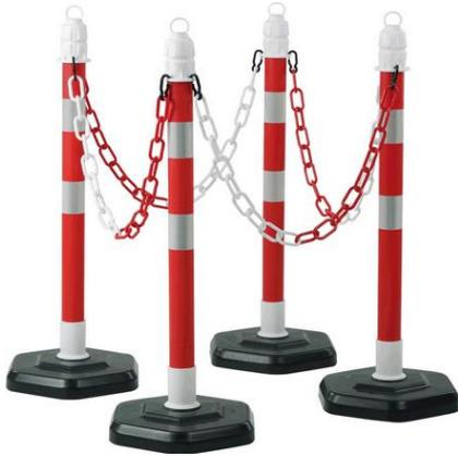
Das rot / weiße Kettenpfosten-Set MULTI MAX hat als Besonderheit einen erweiterten Pfostenabstand. Bei herkömmlichen Kettenpfosten gibt es einen maximalen Kettenabstand von 2 m. Bei diesem Set ist ein Abstand bis zu 4 m möglich. Daher ist der Einsatz dieser Kettenpfosten äußerst flexibel: als Absperrung von Baugruben oder als Personen-Leitsystem.
